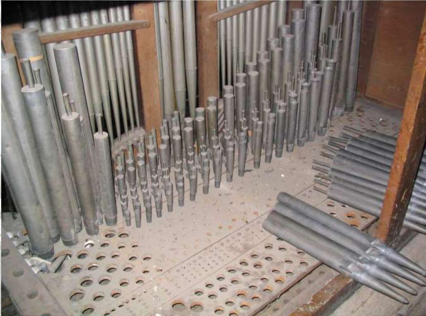
**Ensuite débute le démontage proprement dit. Ici la tuyauterie du positif est déposée soigneusement puis emballée**
