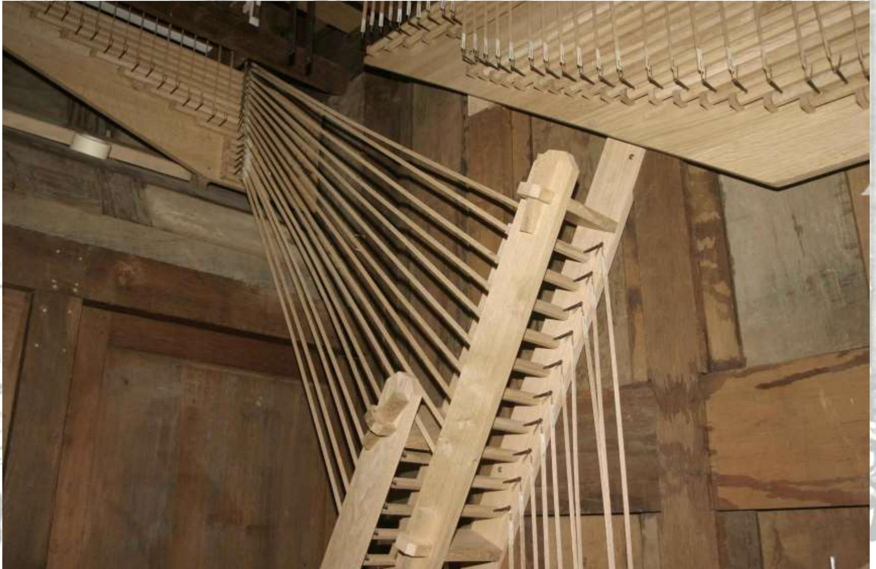
**La mécanique du pédalier passe par un système d'échelles**
