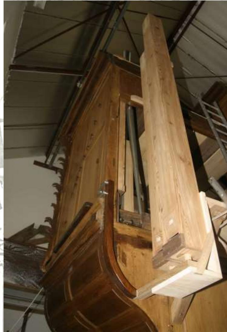
**Les tuyaux d'anches sont maintenus par des râteliers, les plus grands tuyaux en bois sont placés derrière le buffet**
